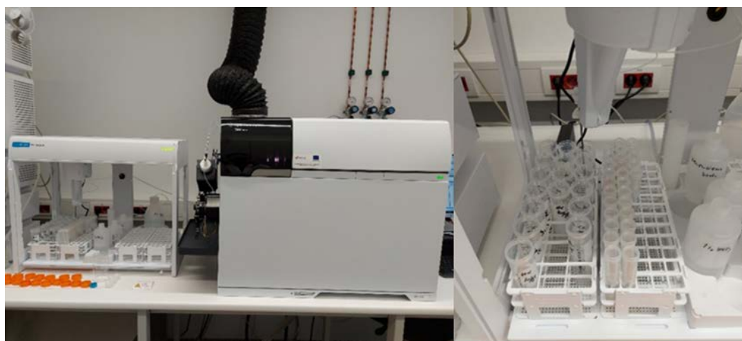
Slika 16. Instrument ICP-MS korišten za određivanje teških metala (a) te njegov dio za automatsko uzorkovanje (b) (vlastite fotografije)
