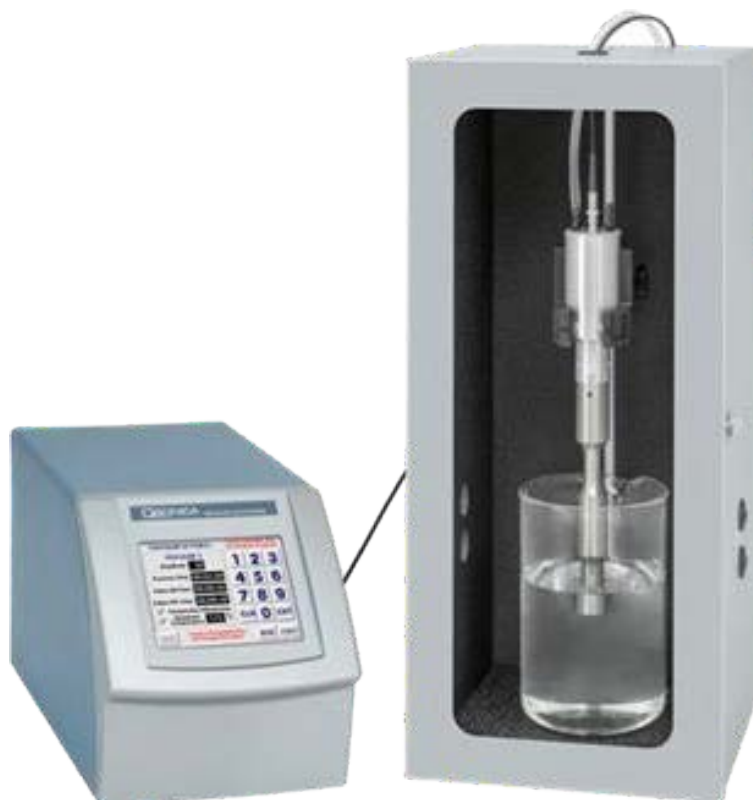
Slika 18. Uređaj za ultrazvučnu ekstrakciju Q700 (vlastita fotografija)
